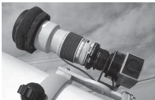
新星を発見したマミヤ 200mm F2.8APO + CCD (BJ-42L)、25cm 反射望遠鏡に同架
